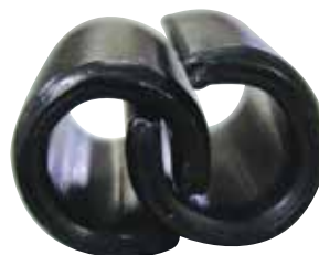
La posibilidad de engarzado de los pasadores ranurados hace extremadamente difícil la alimentación e instalación automática.
