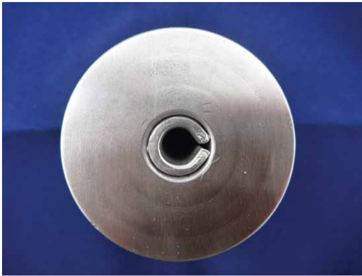
Imagen 5: Pasador elástico ranurado instalado en un orificio mínimo recomendado. Nótese que la separación virtualmente se cierra a lo largo del diámetro interior del pasador.
