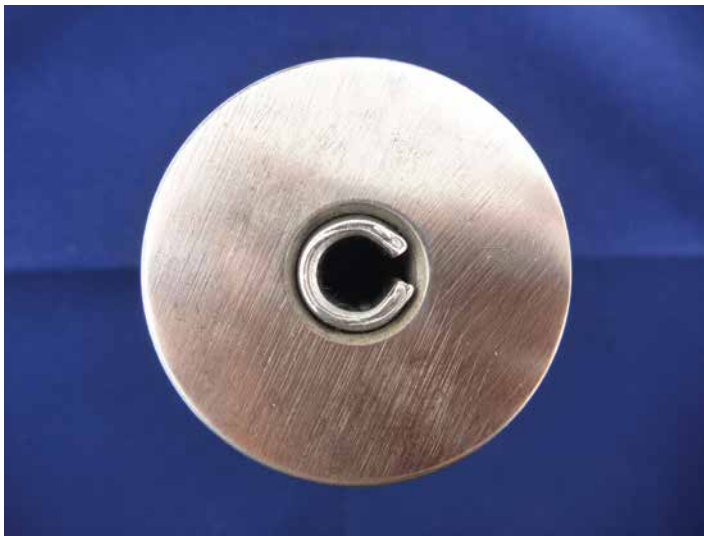
Imagen 6: Pasador elástico ranurado instalado en un orificio demasiado grande.
