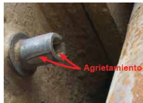
Imagen 3: Un pasador elástico ranurado solo puede doblarse sobre sí mismo 180° del lado opuesto a la separación, como al abrir y cerrar un libro.
