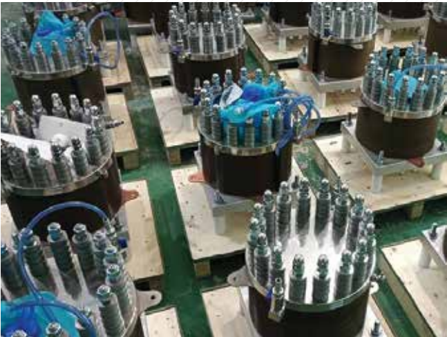
Almacenamiento de celdas de electrólisis
