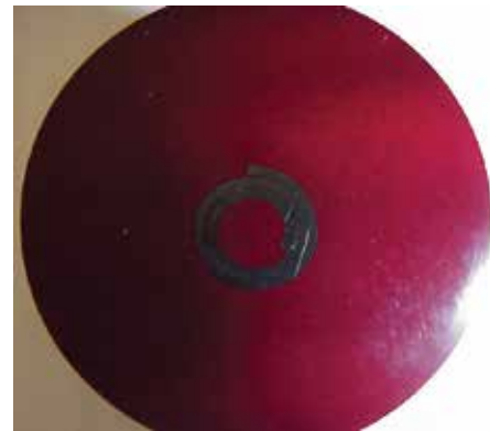
Fotografía de un pasador en espiral montado y pulido, listo para inspección de microdureza
