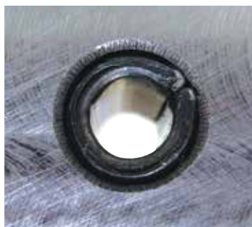
Figura 2. La ranura del pasador ranurado se cierra cuando se instala en un agujero.
