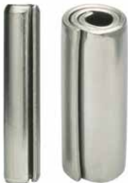
Figura 1: A la izquierda, los pasadores ranurados tienen una forma de "C". A la derecha, los pasadores elásticos en espiral tienen 2 1/4 vueltas en espiral.
