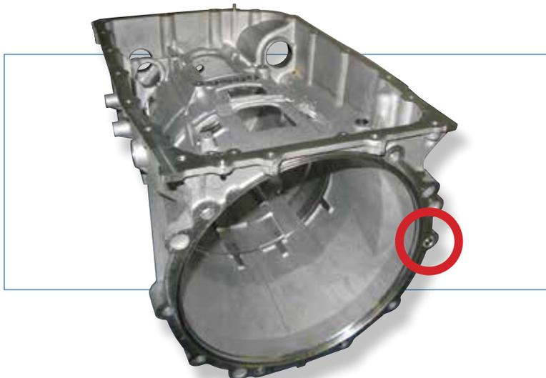
Un fabricante de equipos originales utilizaba un pasador de sólido de 16 mm de diámetro exterior para ubicar la transmisión en la parte trasera del motor. Esta aplicación en particular era más exigente que el resto debido al peso de las dos piezas que debían alinearse y al método utilizado para ensamblarlas. El cliente se acercó a **SPIROL** en busca de sugerencias para reducir costos.
